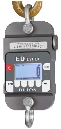
Üstte: Düşük kapasiteli model olan EDjr 1000 kgf (2500 lbf) görülmektedir
